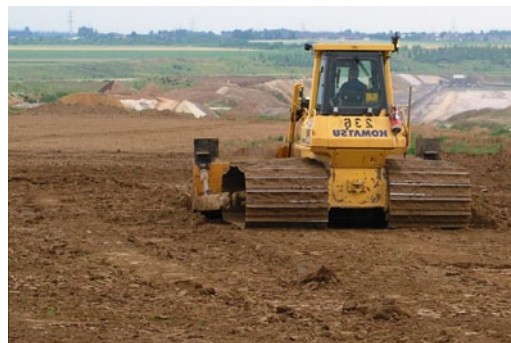
Abb 10: Breitlaufwerke zum Schutz des Bodengefüges – Beispiel aus der Rekultivierungspraxis (© Ingenieurbüro Feldwisch)
