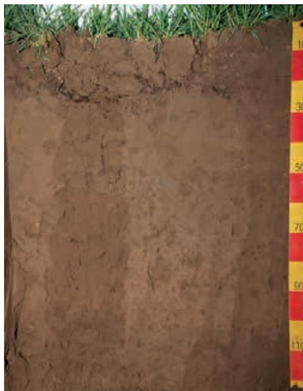
**Abb. 6:** Profilbild eines extrem tiefgründigen Kolluviums aus Löss in Nordhessen, geschätzt als L 1 Lö.
