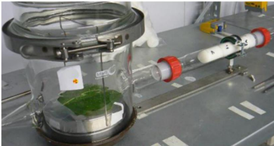
Abbildung 10 Verflüchtigungskammer mit appliziertem Kartoffelblatt (Staffa et al. 2012)
