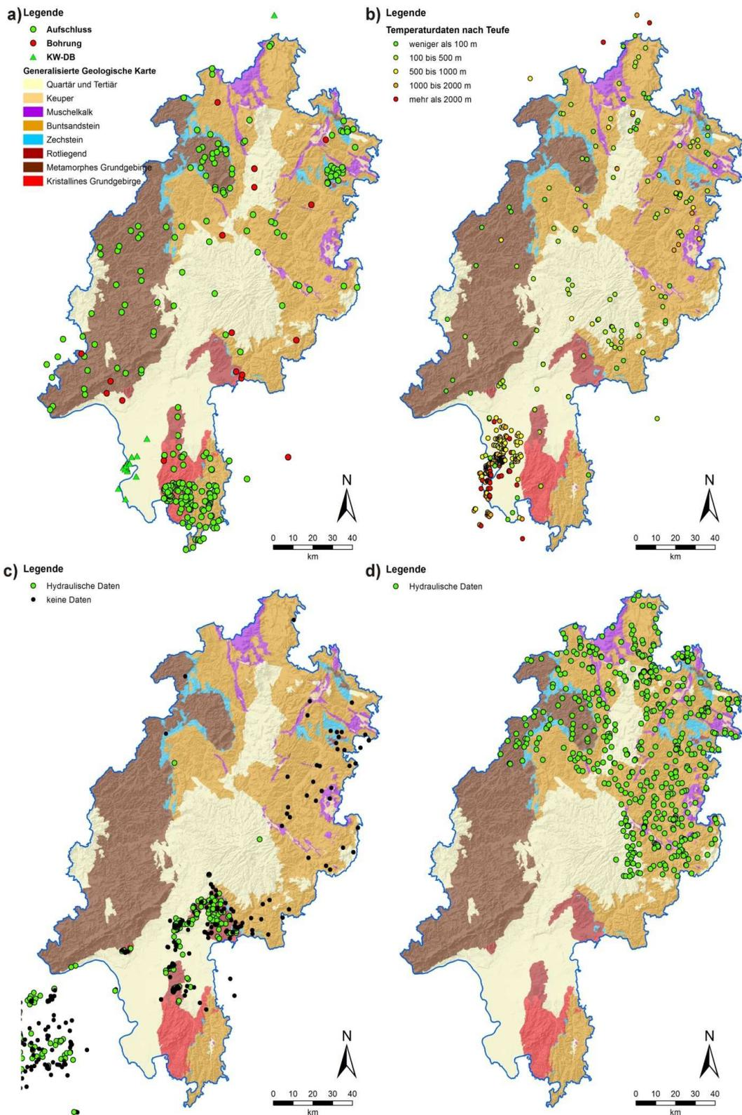
Eingangsdaten für das geothermische Modell. a) Lage der Aufschlüsse und Bohrungen, in denen Proben für Labormessungen entnommen wurden und der in der Kohlenwasserstoff-Datenbank enthaltenen Messdaten. b) Lage der für Hessen vorhandenen Untergrundtemperaturmessungen. Lage der Bohrungen im Rotliegend (c) und im Buntsandstein (d), die auf hydraulische Testdaten gesichtet wurden
