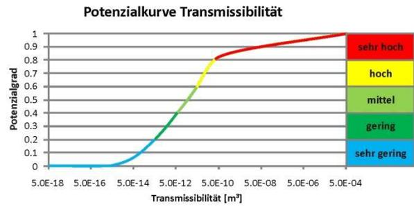
Beispieldarstellung der Potenzialkurven für Wärmeleitfähigkeit, Permeabilität, Temperatur und Transmissibilität
