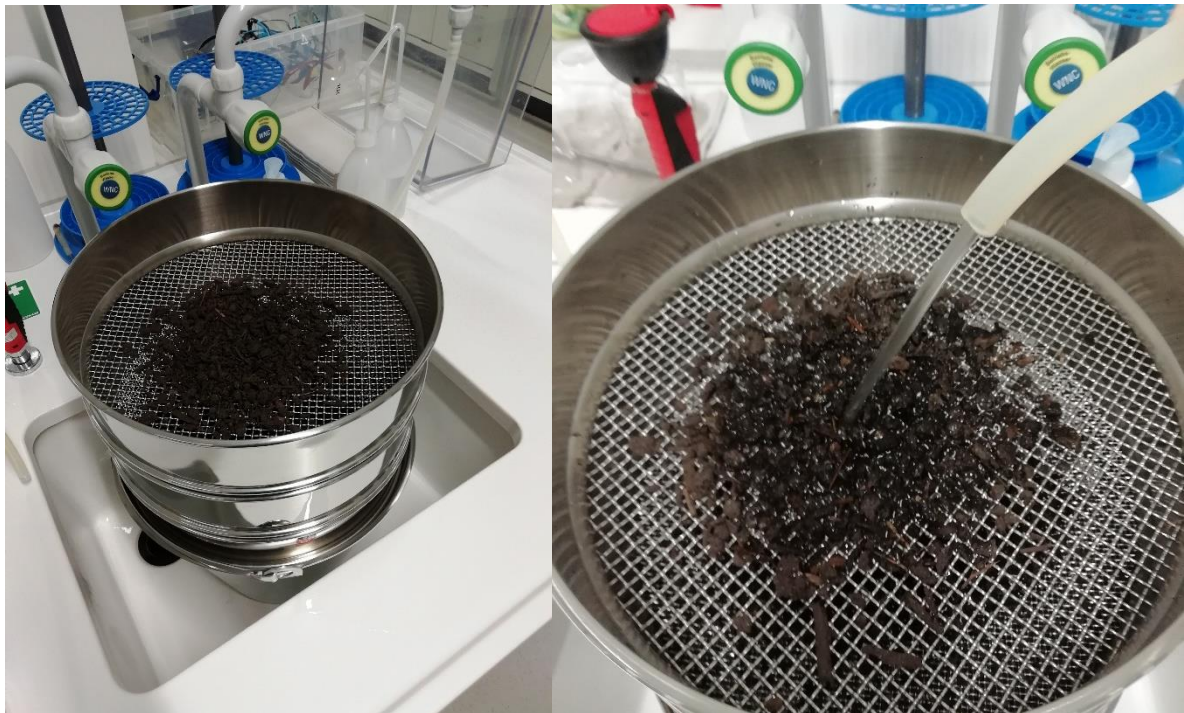
Abbildung 20: Versuchsaufbau mit der Siebkaskade auf dem Edelstahlleimer
