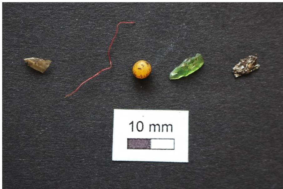
Abbildung 35: gefundene Fremdstoffe der Vergärungsanlage sortiert nach Folien, Fasern, Fragmenten, Glas und Metall / Alu (von links nach rechts)
