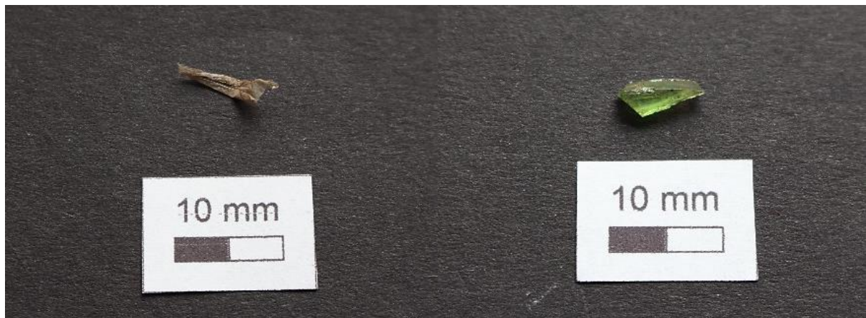
Abbildung 38: Nahaufnahme eines Folienfragments (links) und eines Glasfragments (rechts) in der Fraktion 2-5 mm
