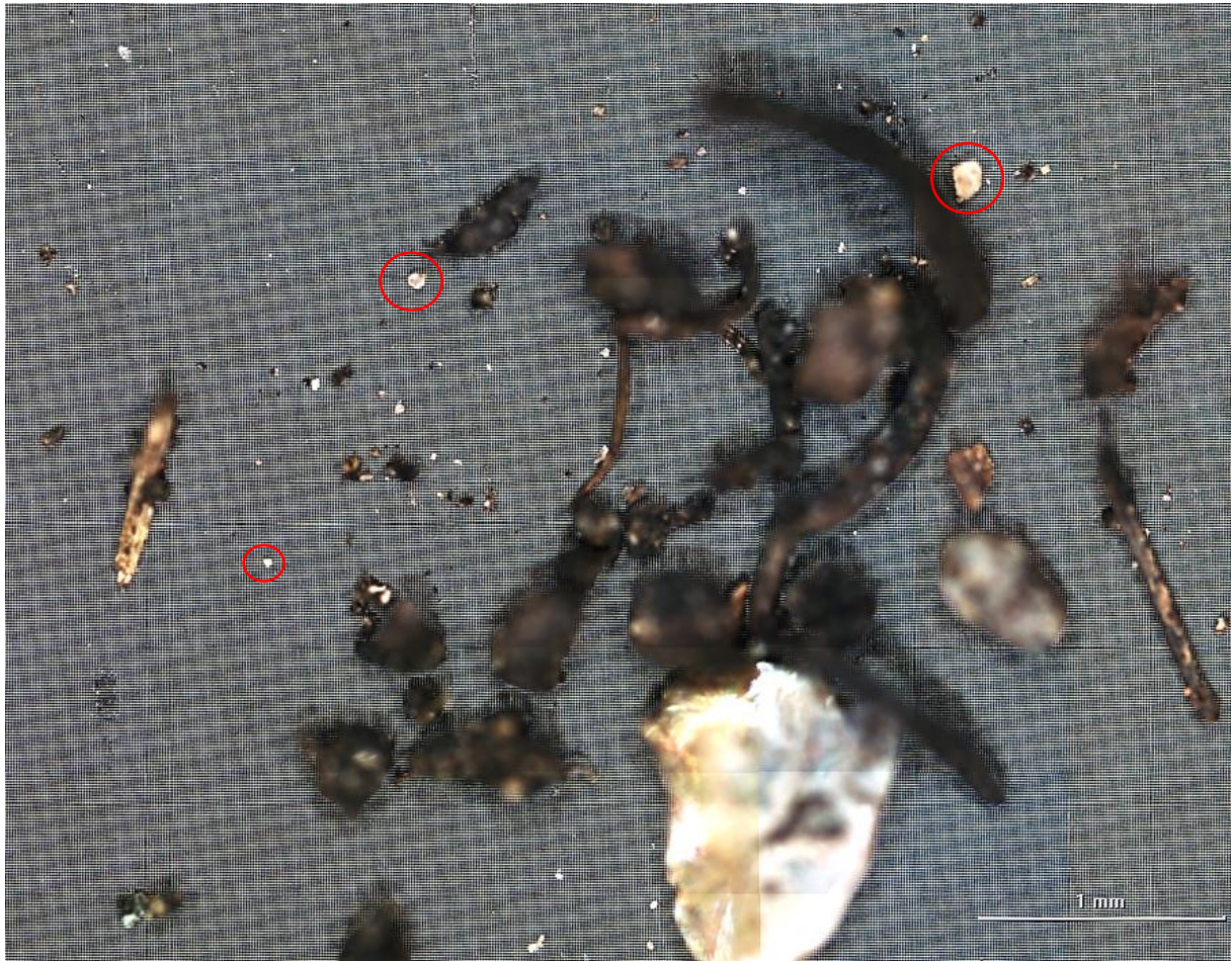
Abbildung 29: Stichprobe der Fraktion < 1\text{ mm} unter dem Raman-Spektrometer
