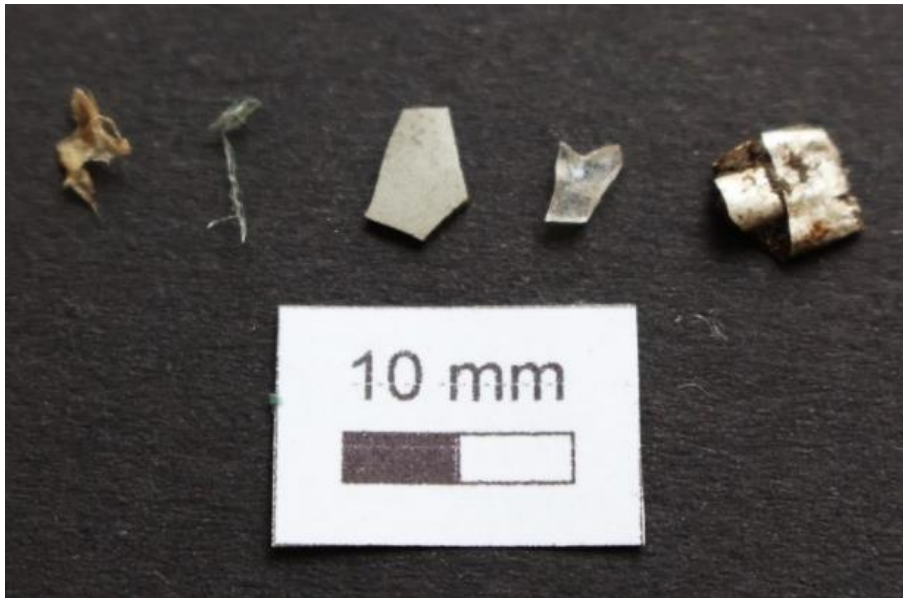
Abbildung 34: gefundene Fremdstoffe der Kompostierungsanlage sortiert nach Folien, Fasern, Fragmenten, Glas und Metall / Alu (von links nach rechts)
