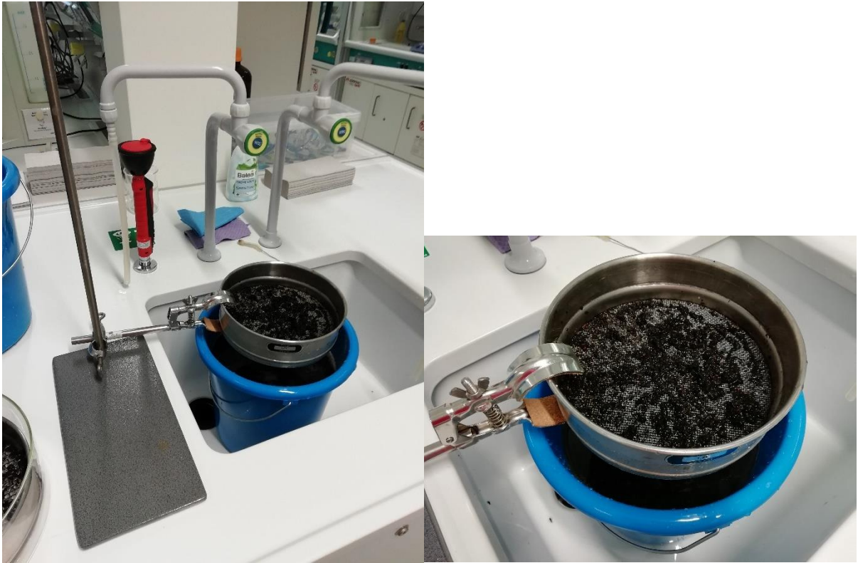
Abbildung 18: Aufbau für die ersten Versuche mit der Komposterde
