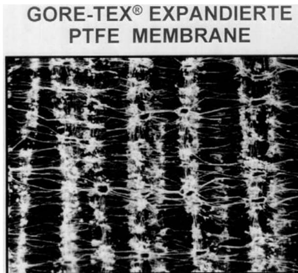
**Abb. 2.** Elektronenmikroskopische Aufnahme einer PTFE-Membran.
