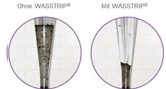
WASSTRIP® verringert signifikant die Bildung von Struvit im Faulturn. Abgebildet ist ein relativer Vergleich des Struvit-Volumens mit und ohne WASSTRIP®.
