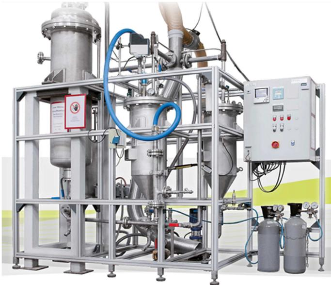
Abbildung 2: Technikumsanlage zur Phosphatextraktion bei Budenheim
