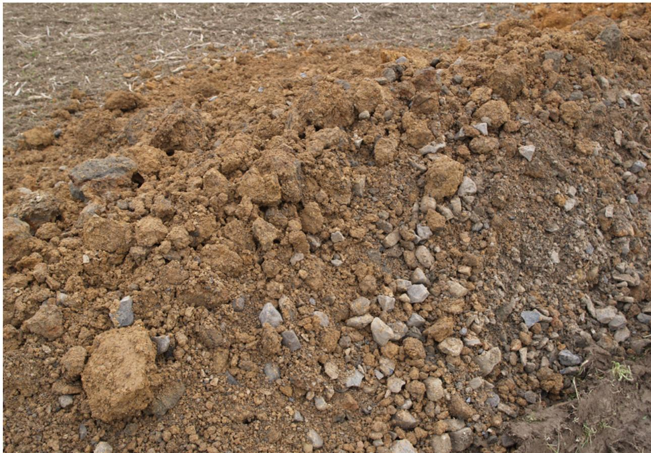
**Abb. 1:** Aufbringung von Bodenmaterial mit zu hohem Steingehalt und zu geringem Humusgehalt © HLNUG
