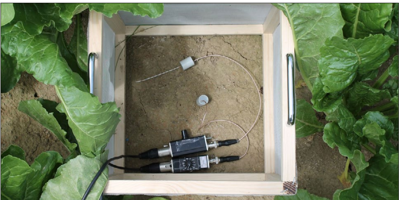
Abb. 6: Sensoren für die Aufnahme der Bodengeräusche © M. Maeder
