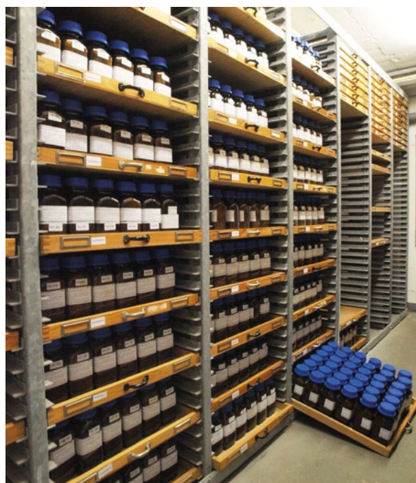
Abb. 1: Blick in die Räumlichkeiten der Bodenprobenbank in Hünstetten-Limbach; links: Einlagerung von Bodenproben in 1 000 ml-Braunglasflaschen in Schwerlastregalen, rechts: Einlagerung von Bodenproben in 500 ml-Vierkant-Braunglasflaschen in Schubladenregalen © HLNUG
