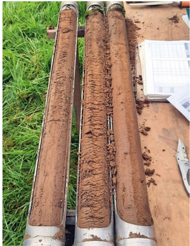
Abb. 3: Aufnahme eines Tiefenprofils mit Hilfe einer Rammkernsondierung © HLNUG
