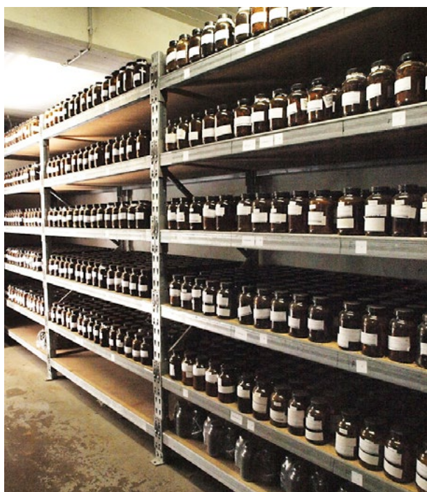
Abb. 1: Blick in die Räumlichkeiten der Bodenprobenbank in Hünstetten-Limbach; links: Einlagerung von Bodenproben in 1 000 ml-Braunglasflaschen in Schwerlastregalen, rechts: Einlagerung von Bodenproben in 500 ml-Vierkant-Braunglasflaschen in Schubladenregalen © HLNUG
