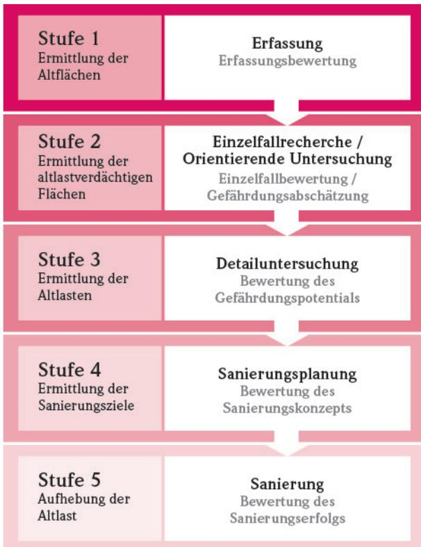
Abb. 1: Stufen der Altlastenbearbeitung in Hessen.
