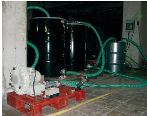
Abb. 3: Fallbeispiel 2 - Seitenkanalverdichter mit 1,1 kW
