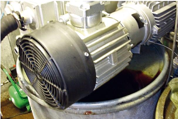
**Abb. 7:** Fallbeispiel 4 – Ölverlust an einem Hochdruckventilator
