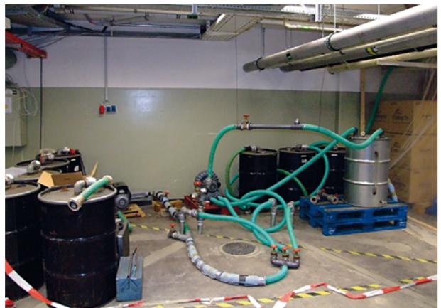
**Abb. 10:** Fallbeispiel 5 - Thermische Bodenluftabsaugung
