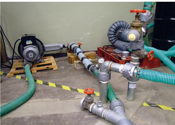
**Abb. 9:** Fallbeispiel 5 – Thermische Bodenluftabsaugung
