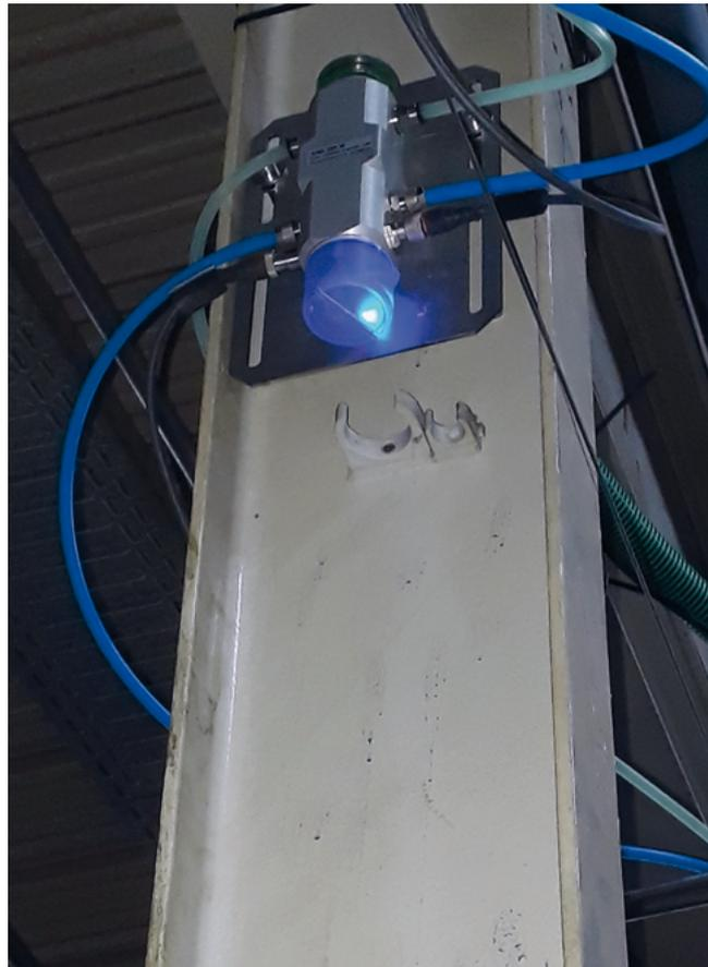
Abb. 5: Bauwerksüberwachung mittels Sensoren an den tragenden Bauteilen
