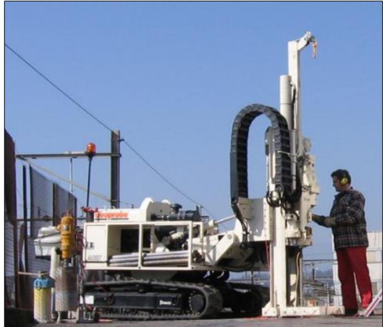
Abb. 2: Kompaktsondiergeräte Geoprobe 6610 DT und 6620 DT
