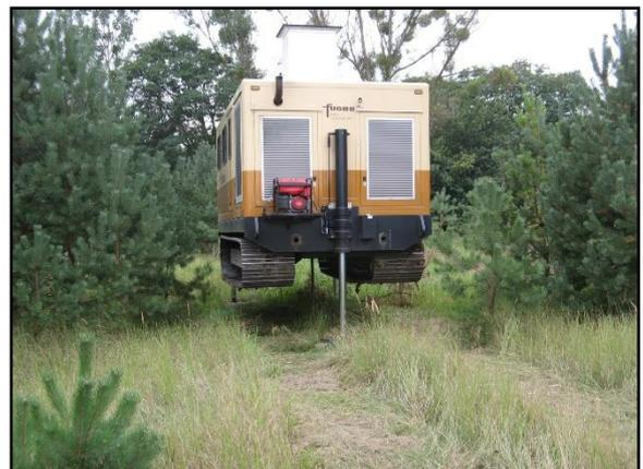
**Abb. 1:** Sondier-LKW (Typ Track-Truck mit absenkbarem Kettenfahrwerk) und vom Transport-LKW absetzbare Sondiertraube
