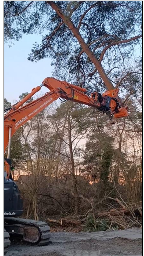
Abbildung 2: Fällgreifer mit Guillotine Bei Bedarf erfolgte eine Zerkleinerung mit einem langsam laufenden Mulcher unter durchgehender Bewässerung zur Vermeidung und Niederschlagung von Staub.
