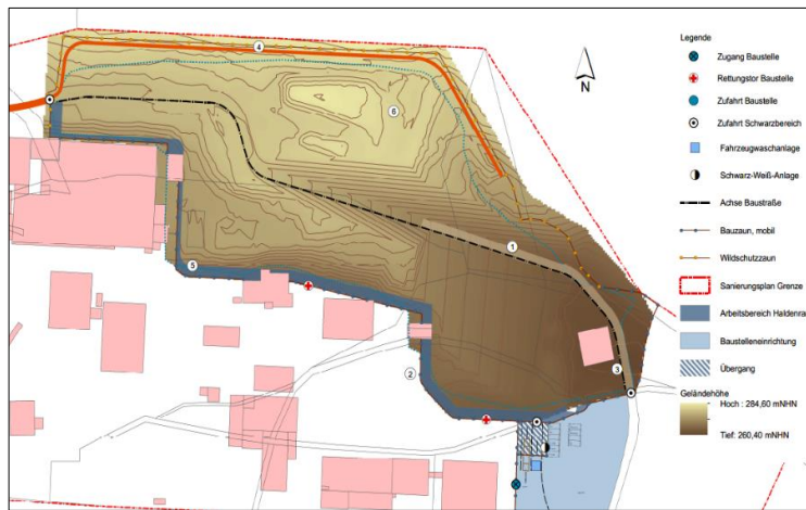
Abb. 4 a-d: Bauphasen 1-4 der Haldensanierung
