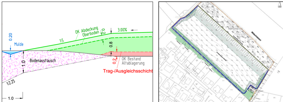
Abbildung 1: Randbereich der Oberflächenabdeckung in Richtung der Privatgärten mit Bodenaustauschmaßnahme sowie allgemeiner Aufbau der Oberflächenabdeckung (links). Bereich der Bodenaustauschmaßnahme (flächig grün) sowie Oberflächenverlauf der Abdeckung (rechts).
