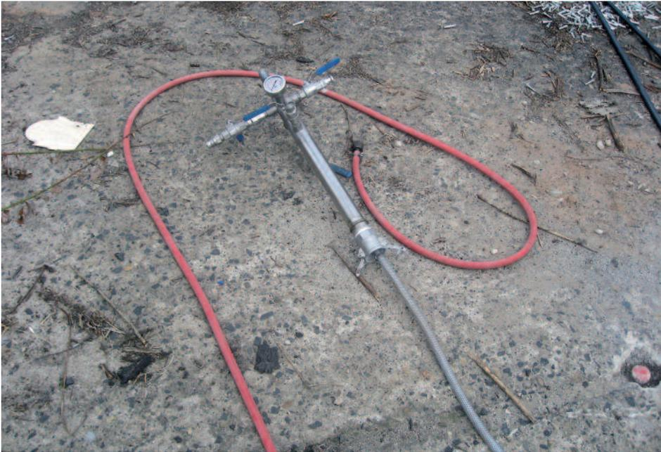
**Abb. 4:** Doppelrohrinfiltrationsstutzen, der auf die Pegel aufgeschraubt wird.
