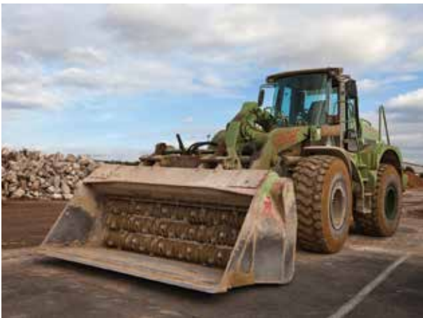
Abb. 4: On-Site Aufbereitung mittels Scheibenseparator.
