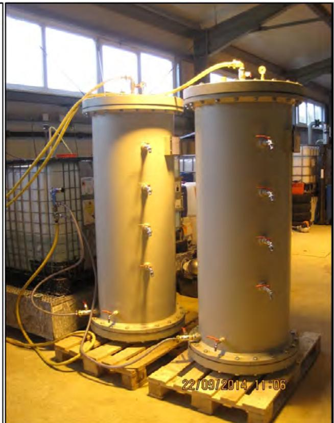
Abb. 5: Aufbau der Lysimeter
