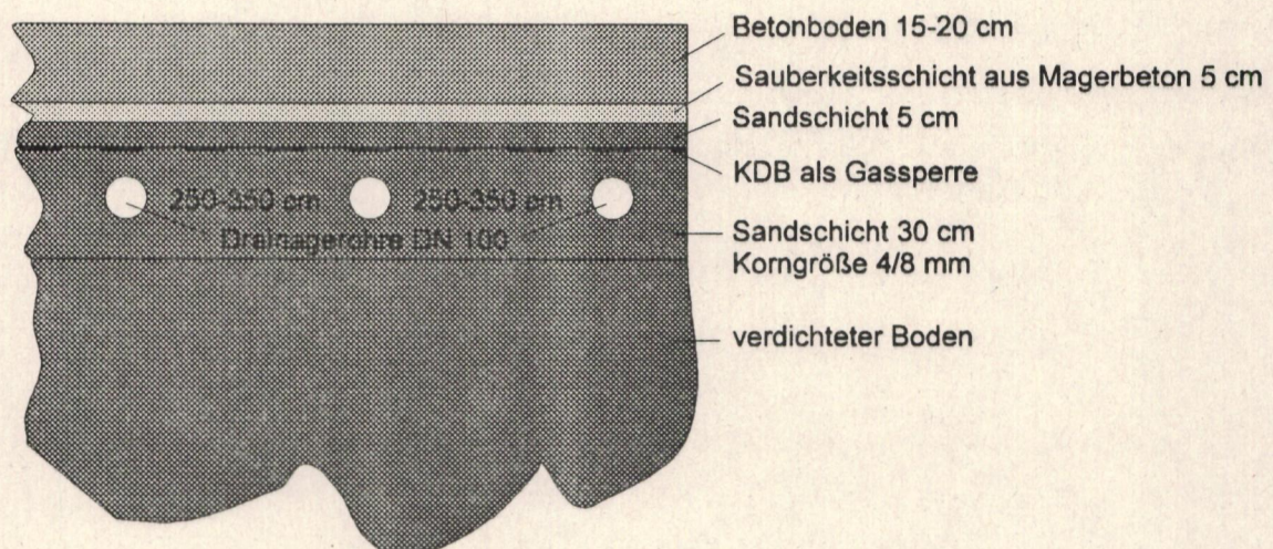
Bild 8: Beispiel für eine gassichere Ausbildung einer Flachgründung
