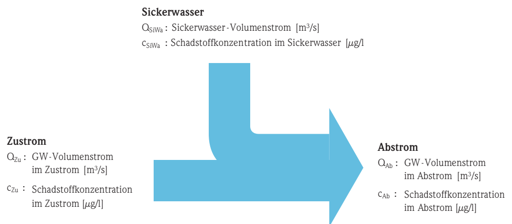
Abb. 8: Schematische Darstellung der Sicker- und Grundwasservolumenströme und Schadstoffkonzentrationen.
