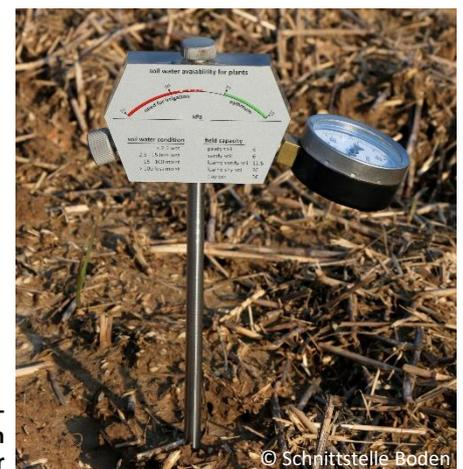
Kontrolle der Bodenfeuchte mit einem Tensiometer
