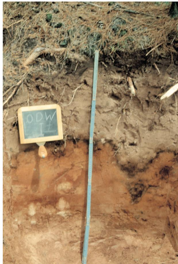
**Abb. 23.** Podsolprofil im Odenwald. Typisch ist der gebleichte Oberboden und die deutlich erkennbare Eisen- und Humusanreicherung darunter.
