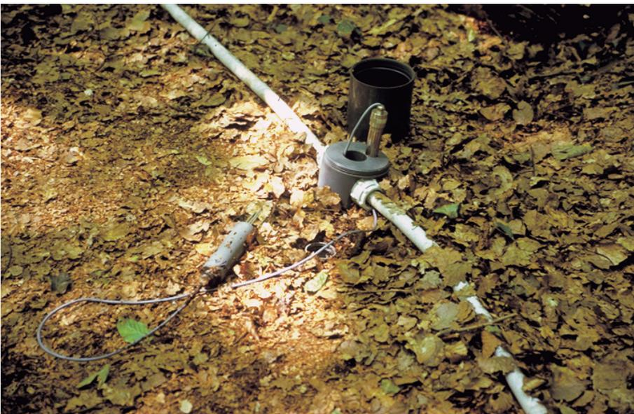
**Abb. 45.** Im Boden fest installierte Messfühler erfassen die Dynamik des Bodenwassers und entnehmen Bodenwasserproben.
