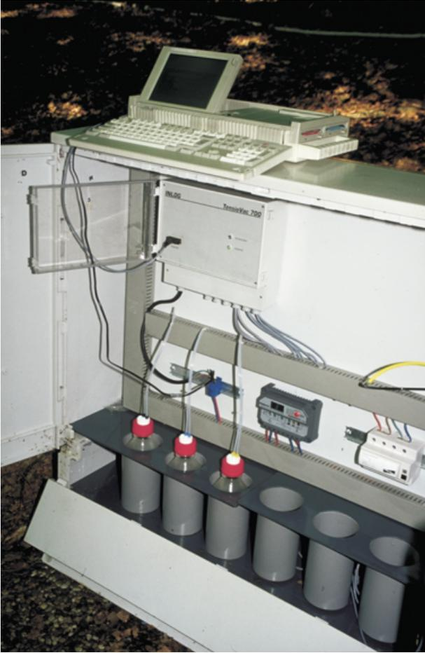
**Abb. 46.** Computergesteuerte Probenahme auf der Intensiv-Boden-Dauerbeobachtungsfläche Hann. Münden.
