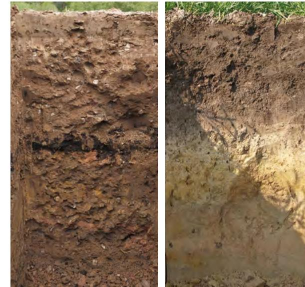
Links ein Boden aus gemischten, verdichteten Kippsubstraten. Problematisch sind der geringmächtige Wurzelraum und die überdeckte Humusschicht. Rechts ein natürlicher Boden mit mächtiger Humusschicht, die gleichmäßig und mit vielen Regenwurm- und Wurzelgängen in den hellen Unterboden übergeht.
