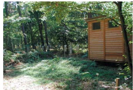
Abbildung 3.4: Messplot FFM_C mit Sickerwassermessfeld (der Messhütte vorgelagert) und Depositionssammlern (links im Hintergrund)
