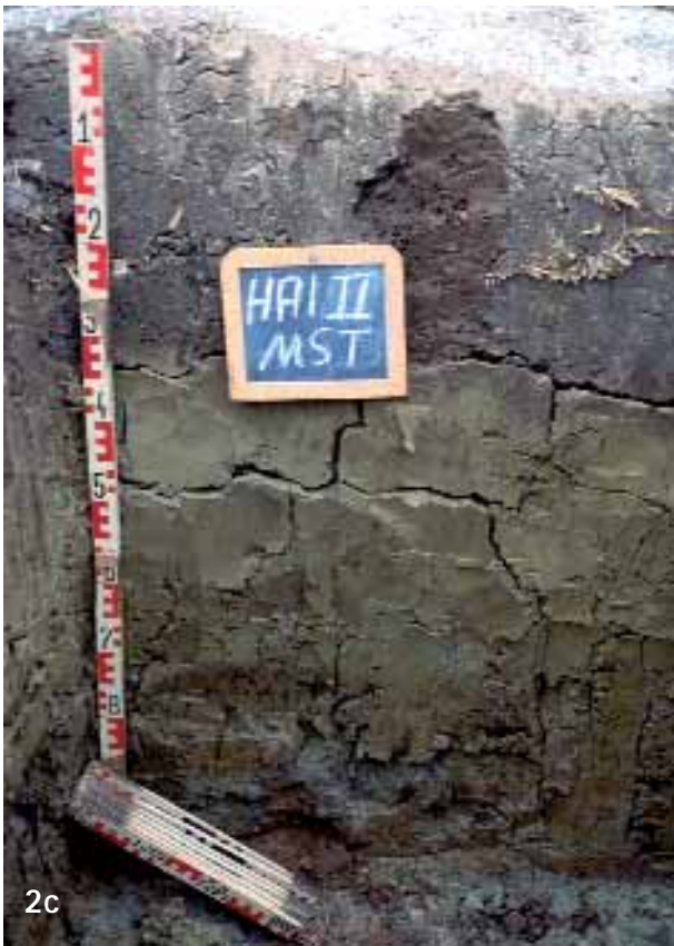
Abb. 2a-d. Für Erdbestattungen ungeeigneter Untergrund. Verschiedenen Beispiele werden in den Anhängen 5–8 vorgestellt und konkretisiert. 2a: Grundwasser beeinflusste Böden (Anlage 5) 2b: Stauwasser beeinflusste Böden (Anlage 6) 2c: Böden mit geringer Luft- und Sickerwasserkapazität (Anlage 7) 2d: Böden mangelhafter Grabbarkeit und Filterfähigkeit (Anlage 8).
