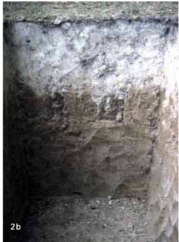
Abb. 2a-d. Für Erdbestattungen ungeeigneter Untergrund. Verschiedenen Beispiele werden in den Anhängen 5–8 vorgestellt und konkretisiert. 2a: Grundwasser beeinflusste Böden (Anlage 5) 2b: Stauwasser beeinflusste Böden (Anlage 6) 2c: Böden mit geringer Luft- und Sickerwasserkapazität (Anlage 7) 2d: Böden mangelhafter Grabbarkeit und Filterfähigkeit (Anlage 8).
