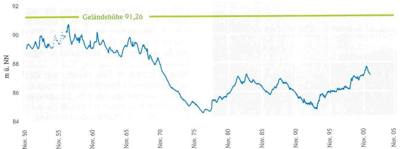
**Abb.4:** Die Messstelle steht im Jägersburger Wald, wo die Absenkung durch Grundwasserentnahme stattfand und der Anstieg durch die Infiltration plus Grundwasserneubildung verursacht ist.
