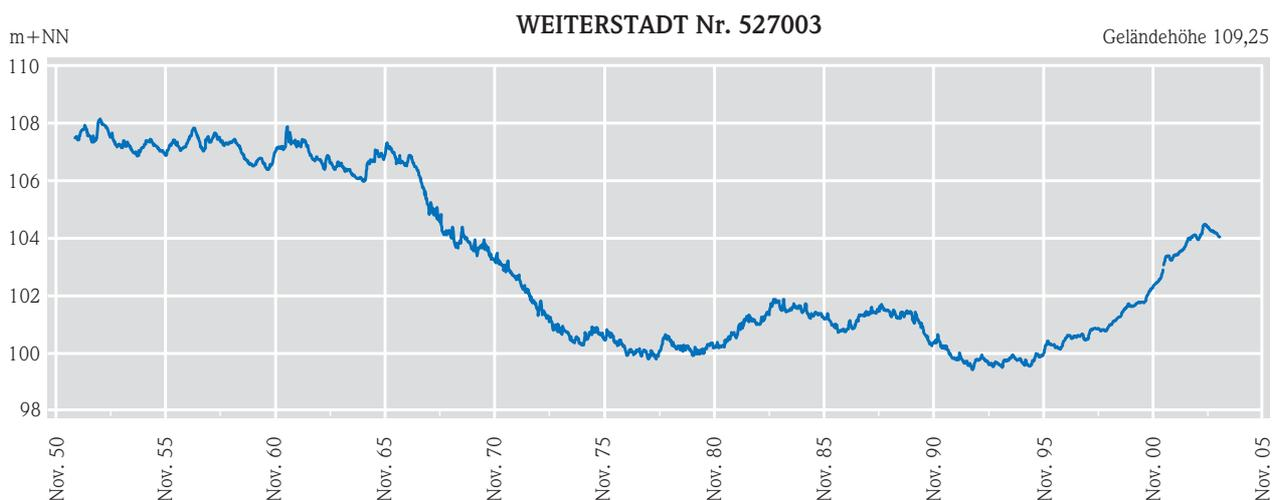
**Abb. 3:** Durch Grundwasserentnahme beeinflusste Grundwasserstände, Messstelle Nr. 527003 Weiterstadt, Zeitraum 1950–2003.
