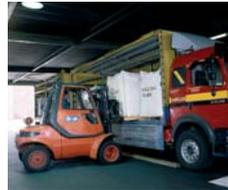
Die Anlieferung der Abfälle zur Untertage-Deponie kann sowohl per LKW als auch per Bahn erfolgen. Die Abfälle können verpackt in Fässern oder Big-Bags, in der UTD Herfa-Neurode zudem per Silo-LKW angeliefert werden (anschließend erfolgt der Umschlag in Big-Bags).
