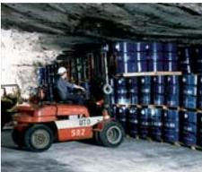
Untertage werden die Abfälle auf Spezialfahrzeugen von dem Förderschacht bis zu den Deponiehohlräumen transportiert. Die Strecke bis zu dem Einlagerungsort beträgt mehrere Kilometer.
