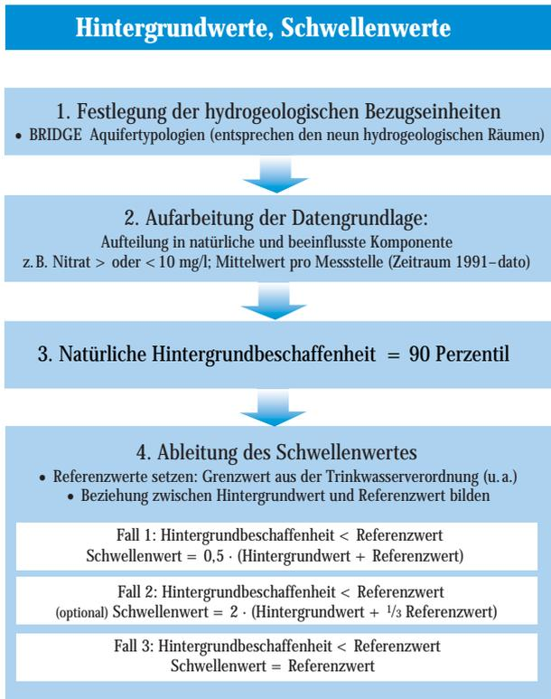
**Abb. 2:** Fließschema zur Ableitung der natürlichen Hintergrundbeschaffenheit sowie Schwellenwerten.
