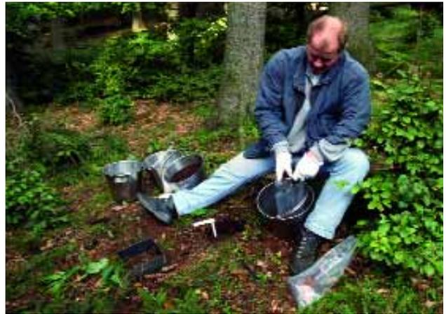
Abfüllen der Bodenproben
