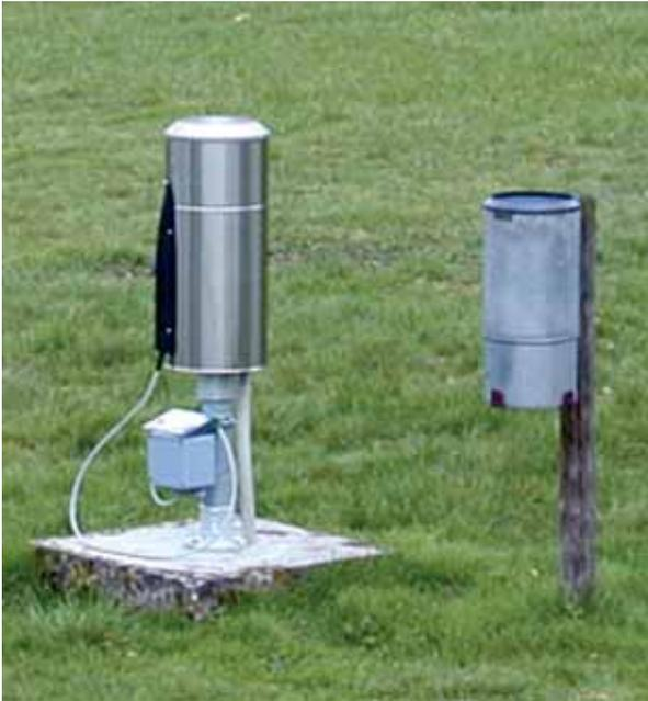
fernübertragung (Ombrometer) ausgestattet. Der Niederschlag wird wie beim einfachen Messer mit einem Auffangtrichter von 200 cm<sup>2</sup> Fläche aufgefangen. Die aufgefangenen Niederschläge werden mit einem elektronischen Wägesystem mit hoher Auflösung (bis 0,01 mm) minütlich erfasst. Das Gewicht des Niederschlags wird über eine elektronisch gesteuerte Auswerteeinheit in ein Ausgangssignal umgewandelt, das an den jeweiligen Datensammler oder per Datenfernübertragung weitergegeben wird.
