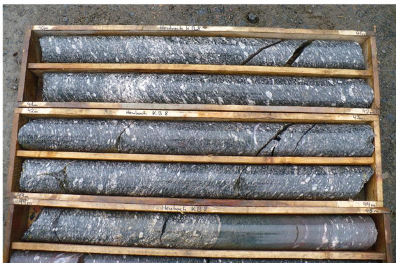
**Abb. 1:** Hornblende-Biotit-Gneis der Bohrung Heubach (40–45 m) mit deutlich zu erkennenden Feldspat-„Augen“ und einer Mylonit-Zone (44,5–44,8 m).
