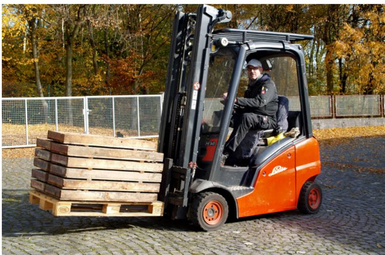
**Abb. 2:** Transport einer Bohrkernpalette mit dem gasbetriebenen Gabelstapler.
