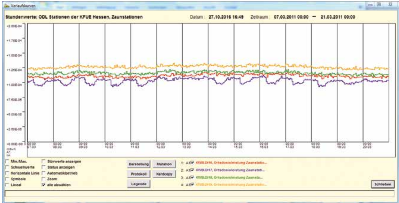
Abb. 3: Ortsdosisleistung der vier Zaunsonden im Verlauf von 2 Wochen (07.03.2011 – 21.03.2011). Deutlich ist der Abschirmeffekt der Bodenstrahlung durch KFZ an den Arbeitstagen Montag bis Freitag zu erkennen (violette Kurve).
