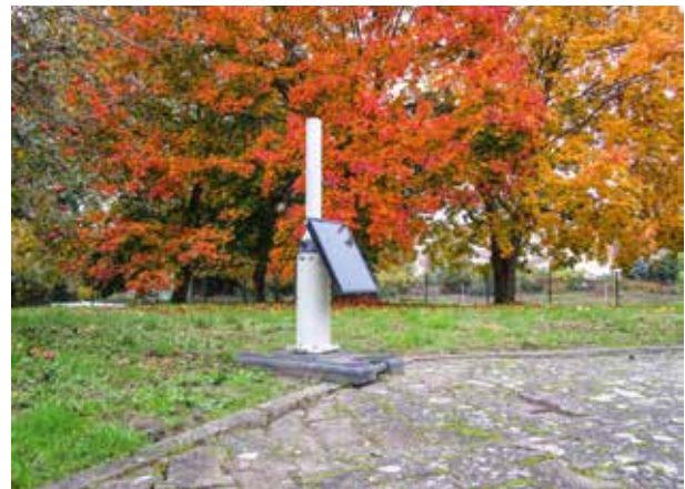
Abb. 4: Autarke ODL-Messstation in Eich.
