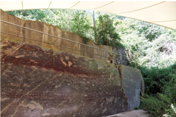
Abb. 3: Die polierte Steinbruchwand des Unica-Bruchs in Villmar bietet einen einzigartigen Einblick in ein mitteldevonisches Stromatoporen-Riff. Der nicht metamorphe Kalkstein wurde seit dem 16. Jahrhundert unter dem Handelsnamen „Lahnmarmor“ abgebaut und ist als charakteristischer Naturwerkstein von überregionaler Bedeutung.
