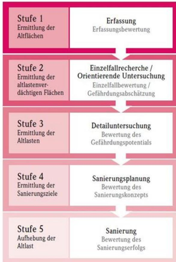
Abb: Stufenmodell der Altlastenbearbeitung
