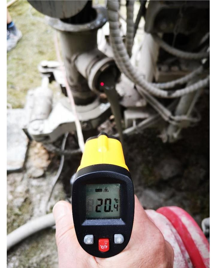
**Nutzung der Erkundungsbohrungen zur wissenschaftlichen Untersuchung des thermischen Einflusses von Bohrvorgang und Bohrlochverfüllung auf die in einer EWS messbare Temperatur in Kooperation mit der TU Darmstadt.**
