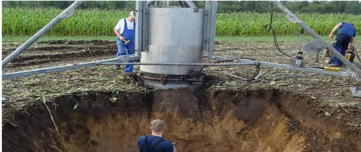
Mit einem Lysimeter kann der Eintrag von Schadstoffen im Boden gemessen werden.
