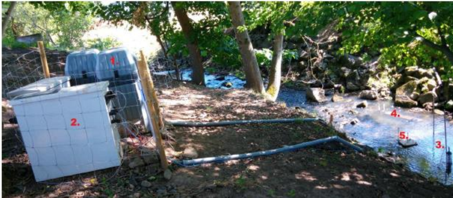
Abb. 7: Technik-Aufbau am Beprobungsstandort: 1. Probenehmer, 2. Steuerung, 3. Wasserstandssensor + Ansaugschläuche, 4. Multiparametersonde, 5. Einzelsonden
