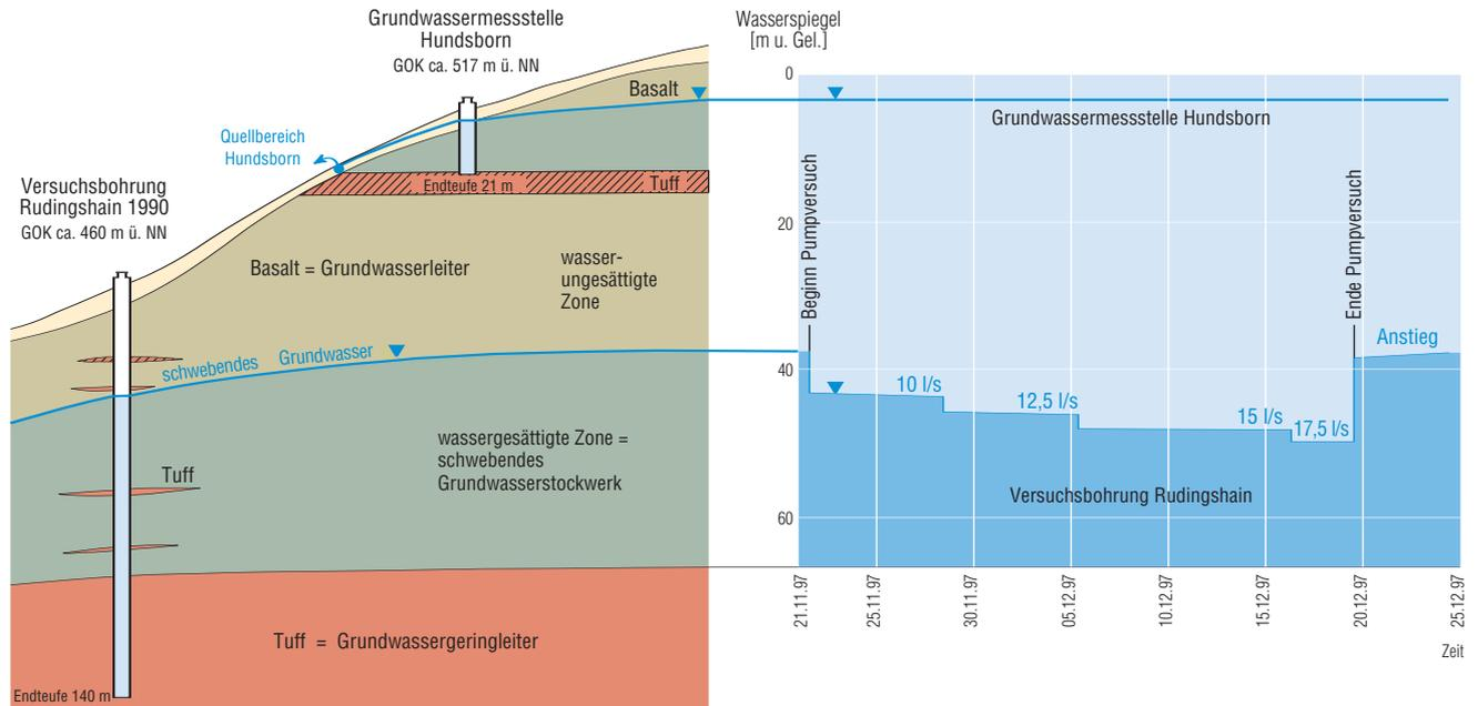
Grundwasserstockwerke mit Grundwassermessstellen.
