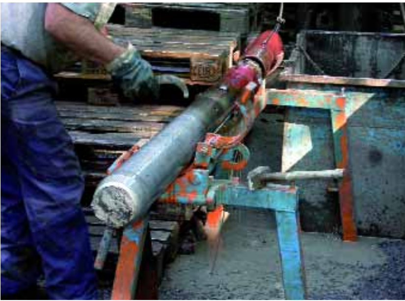
Abb. 4: Ein Kernrohr mit einem ein Meter langen Liner wurde gerade aus 215 m Tiefe geborgen.
