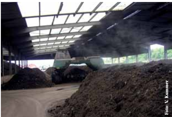
Abb. 1: Überdachte Mietenkompostierung mit Umsetzer.
