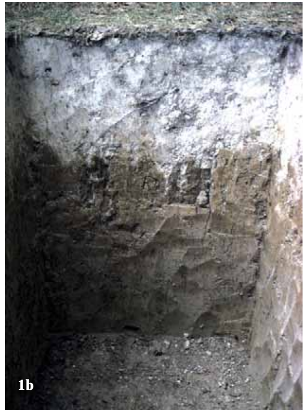
Abb. 1a–d. Für Erdbestattungen ungeeigneter Untergrund. 1a: Grundwasser beeinflusste Böden 1b: Stauwasser beeinflusste Böden 1c: Böden mit geringer Luft- und Sickerwasserkapazität 1d: Böden mangelhafter Grabbarkeit und Filterfähigkeit.
