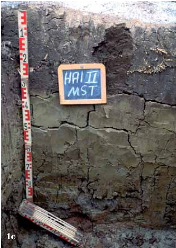
Abb. 1a–d. Für Erdbestattungen ungeeigneter Untergrund. 1a: Grundwasser beeinflusste Böden 1b: Stauwasser beeinflusste Böden 1c: Böden mit geringer Luft- und Sickerwasserkapazität 1d: Böden mangelhafter Grabbarkeit und Filterfähigkeit.
