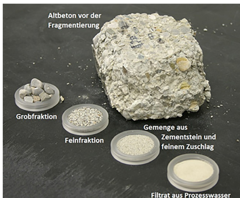
Abb. 3: Fraktion nach der Fragmentierung von Altbeton, dargestellt nach (11).
