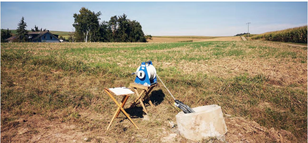
Abb. 1: Temperaturmessung in einer Erdwärmesonde, Wiesbaden-Nordenstadt
