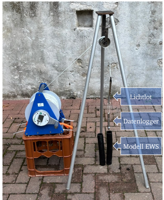
Abbildung 6: Verwendete Messausrüstung mit Dreibein, Temperaturlichtlot und darunter befestigtem Datenlogger. Dargestellt mit Modell-EWS, eigene Aufnahme
