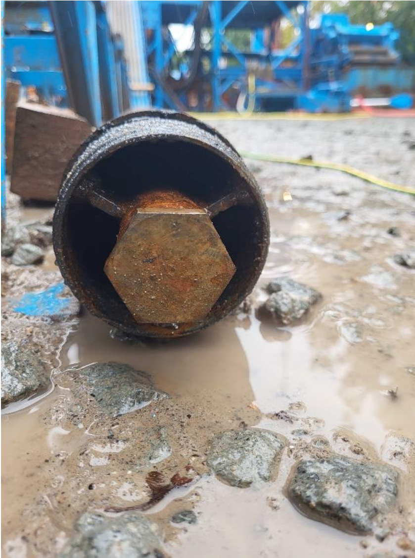
Abb. 11: „Käfig“ im Bohrgestänge, Anfertigung der Fa. Daldrup (Foto: Rumohr).
