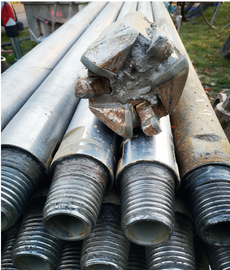
Abb. 2: Klappmeißel für die Herstellung einer EWS-Bohrung mit einem Durchmesser von 180 mm (Foto: S. Rumohr)
