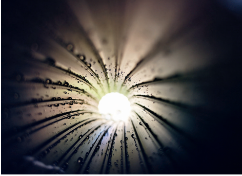
Abb. 6: Rippen an der Innenwandung eines EWS-Rohres zur Erreichung einer quasi-turbulenten Strömung des Wärmeträgermittels (Foto: S. Rumohr)
