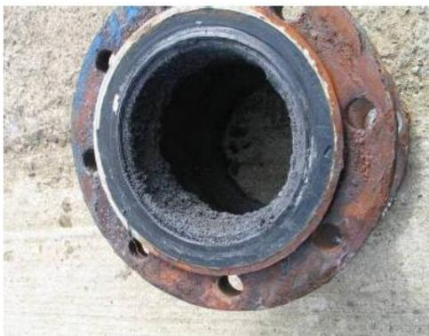
Im Oberrheingraben: Calciumkarbonate, Eisen- und Kupfersulfide (Pyrit, Chalkopyrit), bei  $> 90^{\circ}\text{C}$  Bleiverbindungen (Galenit) und Ba-Sr-Sulfate als Scales in Rohrtouren
