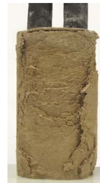
Probekörper im Grundzustand (links), nach 2 Frost-Tau-Zyklen (rechts) Höhe: 18 cm, Durchmesser 10 cm
