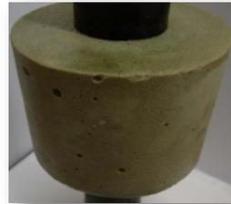
Prüfkörper eines Verpressmaterials nach 6 Frost-Tau Zyklen von (-10°C bis +8°C)
